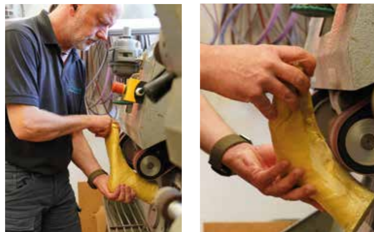
Blauabdrucke und Erfahrungswerte nutzen, um optimal zu schleifen. Use blueprints and experience to achieve optimal sanding results.
