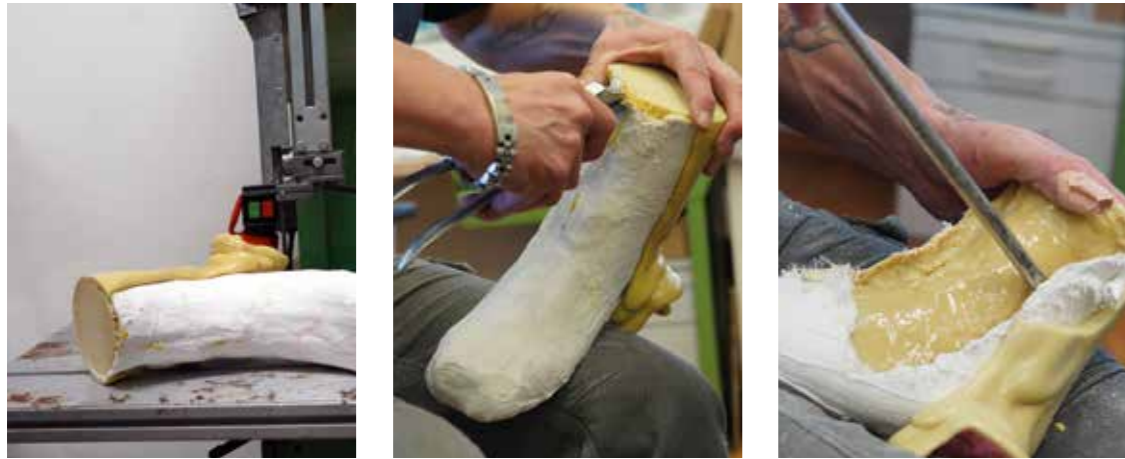
Den Gips mit einem Stemmeisen oder anderen Werkzeug entfernen. Remove the plaster mold using a chisel or other suitable tools.
