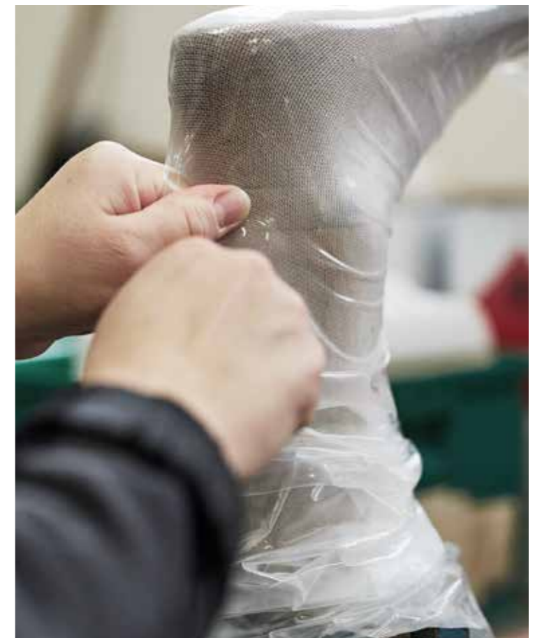
Überziehen eines Beinleistsens mit unserem PVA-Folienschlauch
