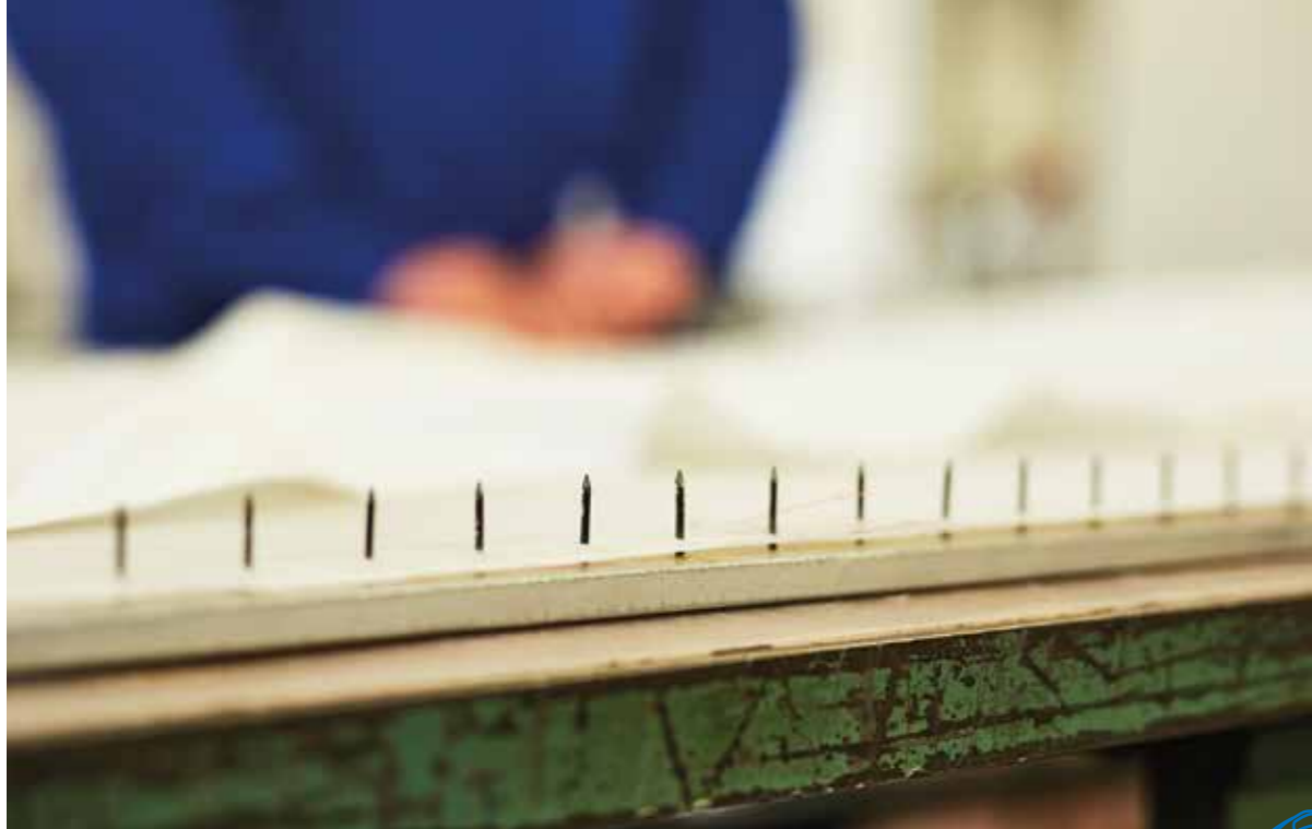
Bespannen des Nagelrahmens für die BKF Acrylplattenproduktion
