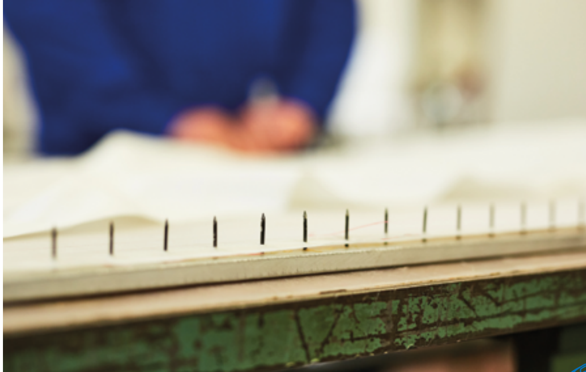
Bespannen des Nagelrahmens für die BKF Acrylplattenproduktion
