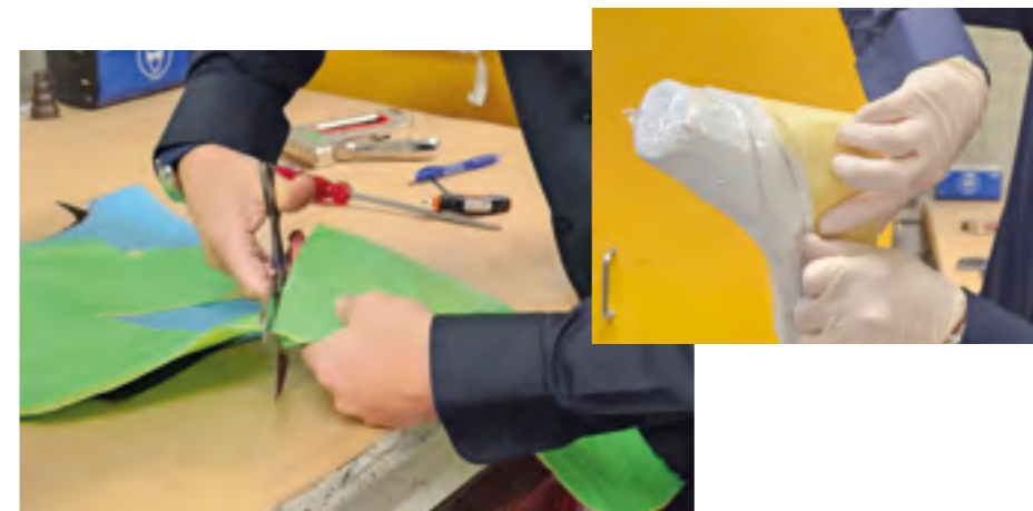
← Erste Lage: Aramitfaser zuschneiden und auflegen First layer: Cut and position the aramid fibre
